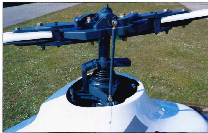
Frezowana aluminiowa głowica wirnika nośnego
