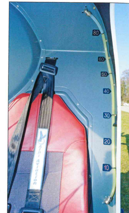
Wskaźnik paliwa jest z lewej strony fotela pilota
