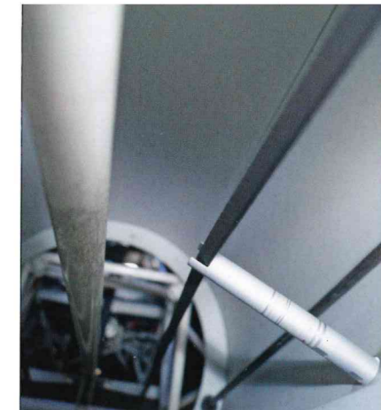
Dynamometr do kontroli napięcia pasów klinowych napędzających wirnik ogonowy i sposób pomiaru
