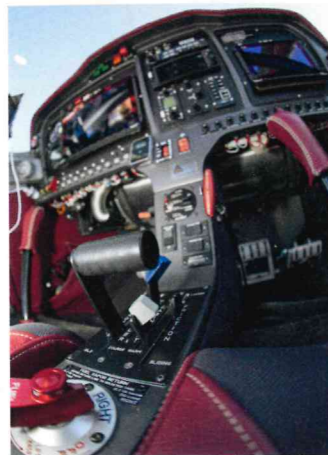
Ungewöhnlich Rettungssystem in einem Viersitzer – der Griff ist oben an der Mittelkonsole. Dahinter: Gas, Prop, Kabinenheizung und Tankwahlschalter
