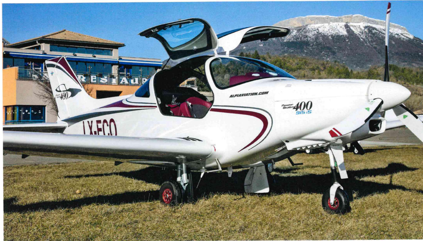
Komplexes Kitplane Mit Einziehfahrwerk und Verstellpropeller ist die Pioneer 400-915 IS alles andere als schlicht. Auch die Flügeltüren sind eher ungewöhnlich für ein Selbstbauflugzeug
