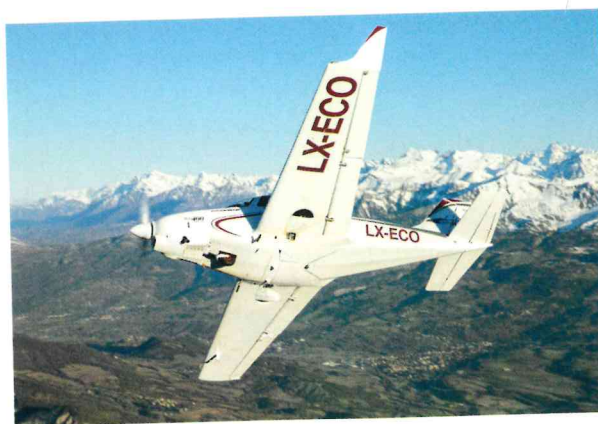
Echo-Klasse Auch in Deutschland kann die »400« nur als Experimental zugelassen werden. Von unten ist gut zu sehen, dass das Bugrad nicht ganz im Rumpf verschwindet
