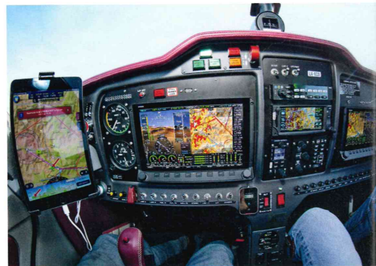
Jede Menge Glas Dynon HDX 1100 (links) und HDX 800 dominieren das Panel, dazwischen ein Garmin GTN 650, ein zweites Funkgerät, Mode-S-Transponder mit ADS-B out sowie Autopilot
